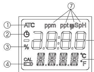
1. indicatore di compensazione automatica della temperatura (ATC)
